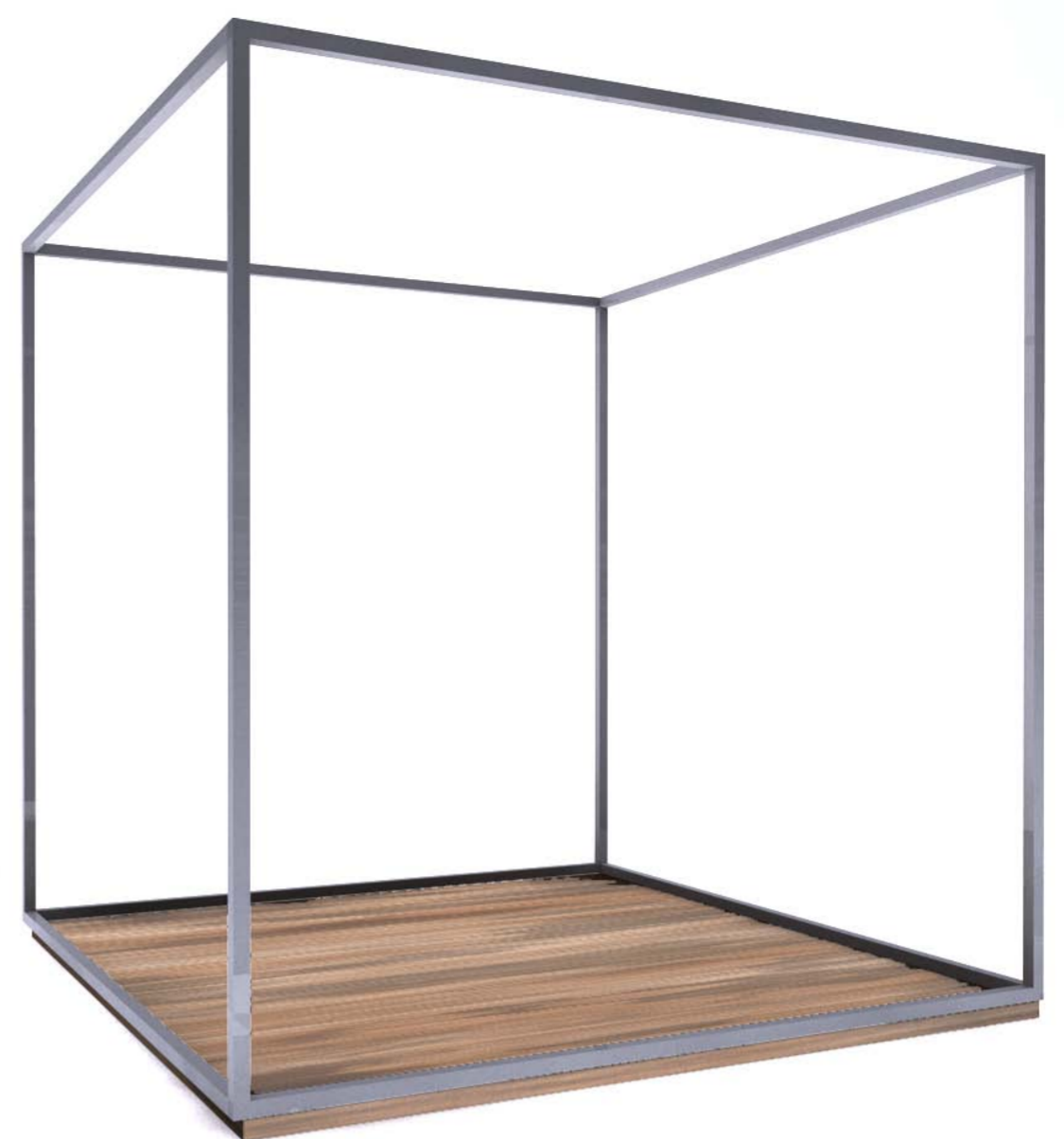
Skelettkonstruktion aus Steckelementen (Außenkubatur)
